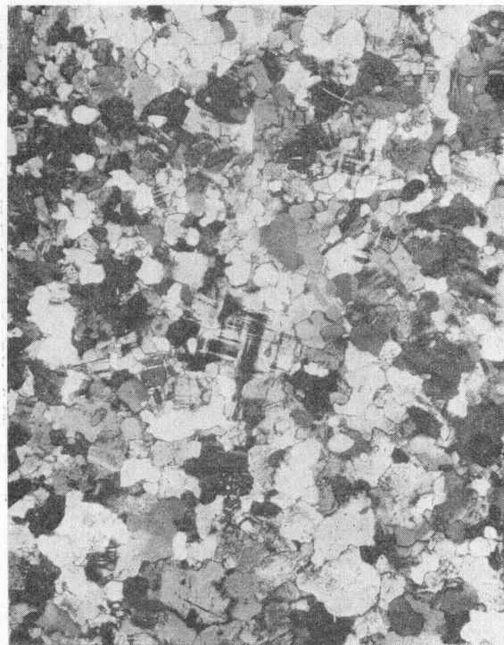
Foto 14.—SO-17. Aplita: Textura apítica, mostrando granos de cuarzo y de microclino de grano muy uniforme. Nicols cruzados, 36 x.
