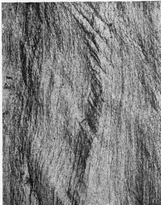
Foto 8.—SO-141. Pizarra. Textura pizarrosa, «Strain slip cleavage». Nícoles paralelos, 36 x.
