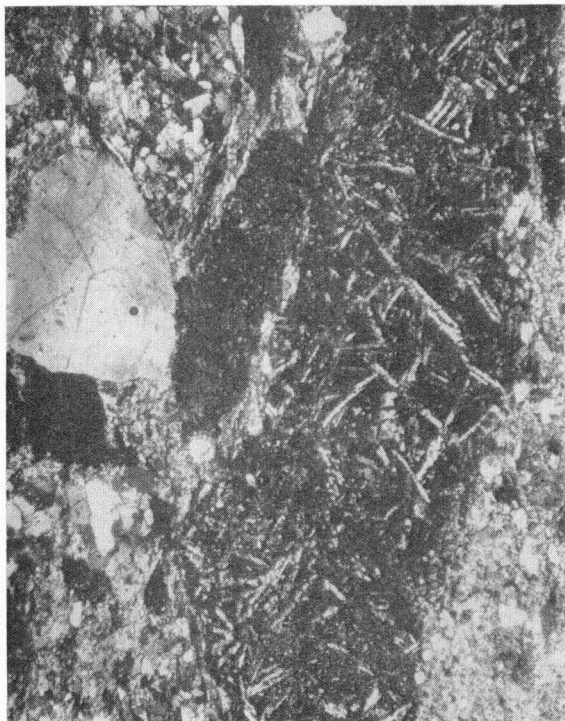
Foto 5.—SO-186 A. Grauvaca: Fragmentos espiliticos, cuarzo y carbonato. Nicoles cruzados, 36 x.
