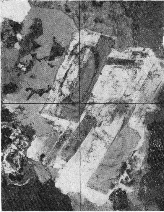
Foto 16.—SO-214. Granodiorita: Fenocristales de plagioclasa zonados y maclados. Nícoles cruzados, 36 x.
