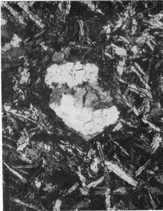
Foto 10.—SO-200 C. Dolerita: Textura ofítica. Nícoles cruzados, 36 x.
